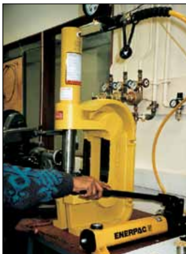
◀ Uma Prensa mecânica A-310 usada para compactar pó a 10 tons.
