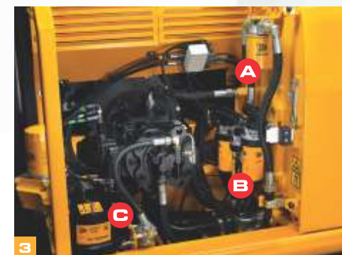
(A) Filtros de óleo hidráulicos (B) Filtros de combustível (C) Sistema de Filtragem de Óleo JCB Plexus
