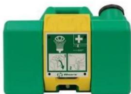
Especialmente projetado para atividades de risco em campo e distante de fontes de água. Produzido em polietileno de alta densidade, produto de acionamento manual, possui alça que facilita o seu transporte em situação de emergência. Puxando o lava-olhos para baixo haverá um fluxo de lavagem. O produto possui capacidade de 36 L com fluxo de 1,5 L/min, o que por sua vez, cria uma lavagem completa através dos esguichos lava-olhos.
