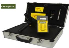
O opacímetro é um aparelho para medição da opacidade da fumaça emitida pelos motores diesel, atendendo as mais críticas exigências de utilização. Adicionalmente, permite a leitura dos valores de fumaça em duas escalas Porcentagem (%) e o Coeficiente de Absorção de Luz  $k (m^{-1})$ ; calcula as médias das leituras e imprime relatório na impressora incorporada ao seu monitor.
