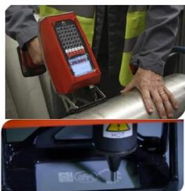
A Pistola de Marcação Portátil é alimentada por bateria e totalmente autônoma. Graças a sua bateria recarregável, ela não tem cabos que possam causar choques ou riscos ao operador. Leve e versátil, a Pistola de Marcação Portátil é ideal para a identificação de peças pesadas ou de difícil acesso. Robusta e altamente confiável, a alta precisão mecânica deste equipamento permite qualidade avançada na marcação, a qual é feita por micropuncionamento.
